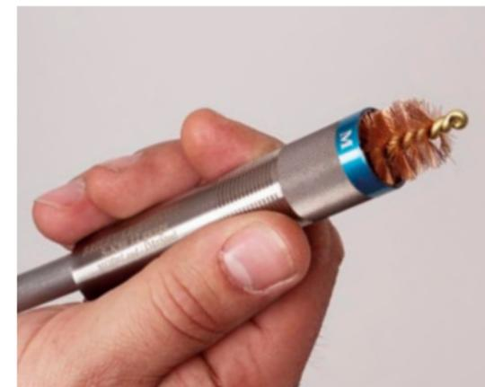
Nach der Reinigung ist es unbedingt erforderlich, den Wechselchokeeeinsatz ganzflächig mit einem dünnen Harz sowie säurefreiem Waffenöl einzusprühen.
