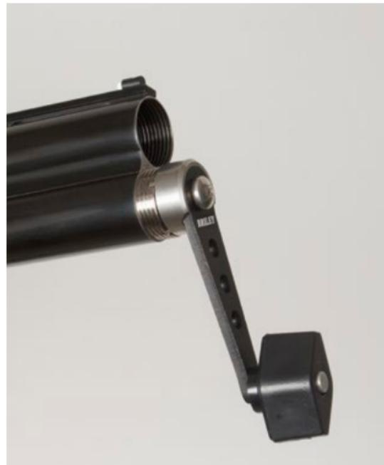
Je nach Verschmutzungsgrad der Wechselchokeeeinsätze können diese bei geringer Verschmutzung einfach mit einem dünnflüssigen Waffenöl eingesprüht und danach mit einem Lappen abgerieben werden.
