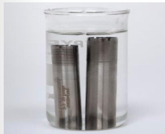
Auf diese Weise werden auch Kunststoffablagerungen im Innendurchmesser des Wechselchokes sehr gut angelöst, sodass diese dann mit geringem mechanischem Reinigungsaufwand entfernt werden können.
